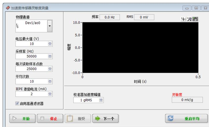
图 2-31 加速度传感器灵敏度校准
